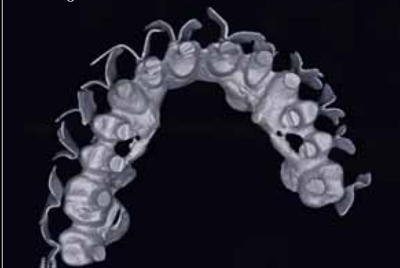
Abb. 55 Vestibulär angebrachte Flügelchen sorgten für eine gerichtete Erstarrung der Legierung – hin zur Muffelwandung
